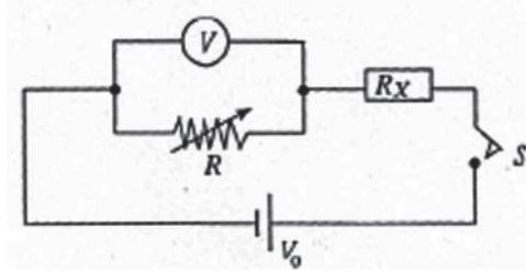
පෙන්වා ඇති පරිපථයට සම්බන්ධ කර ඇති නොදන්නා ප්‍රතිරෝධයක අගය,  $R_x$  ප්‍රස්ථාර ක්‍රමයක් භාවිත කොට සෙවීමට ශිෂ්‍යයකුට නියම ව ඇත.  $R$  යනු ප්‍රතිරෝධ පෙට්ටියක් මගින් සපයන විචල්‍ය ප්‍රතිරෝධයකි.  $Y$  යනු  $R$  හරහා සම්බන්ධ කර ඇති වෝල්ටීම්මීටරයේ පාඨාංකය වේ. වෝල්ටීම්මීටරයේ අභ්‍යන්තර ප්‍රතිරෝධය විශාලය.  $3V$  අගයකින් යුත්  $V_0$  වෝල්ටීයතාව සැපයීම සඳහා එක් එක් විවිධ වෝල්ටීයතාව  $1.5 V$  වන නව විශලී කෝෂ දෙකක් භාවිත කර ඇත. එවැනි විශලී කෝෂ බැටරියක අභ්‍යන්තර ප්‍රතිරෝධය නොගිණිය හැකියැයි සලකන්න.
